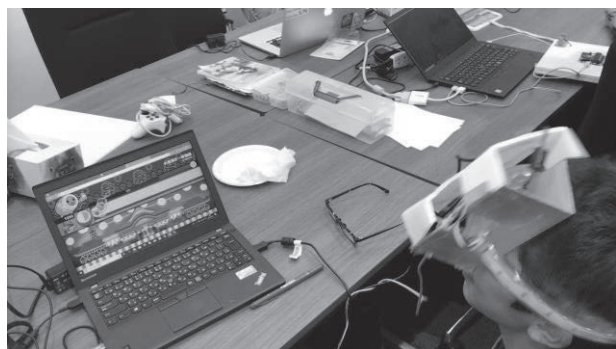
図6 帽子型コントローラの自作により、首振り運動あるいは腹筋運動により音楽ゲーム「太鼓の達人」をプレイする事例
