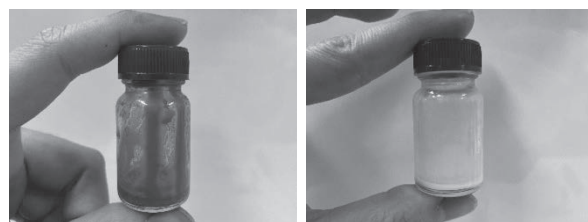
図2: フリクションインクの発色時(左)と消色時(右)の様子
