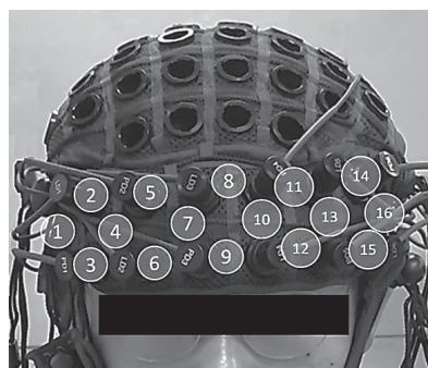
図1 NIRS 装置による計測部位とチャンネル番号
