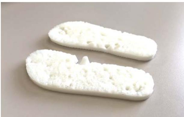
図 5 3D プリンタにより再現した足ツボ状地形。
