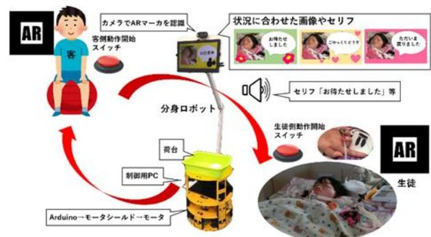
図1 システム構成と遊びの流れ
