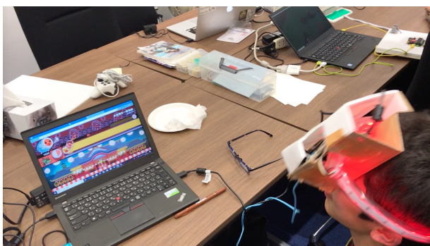
図 6 帽子型コントローラの自作により、首振り運動あるいは肩腕運動により音楽ゲーム「太鼓の達人」をプレイする事例
