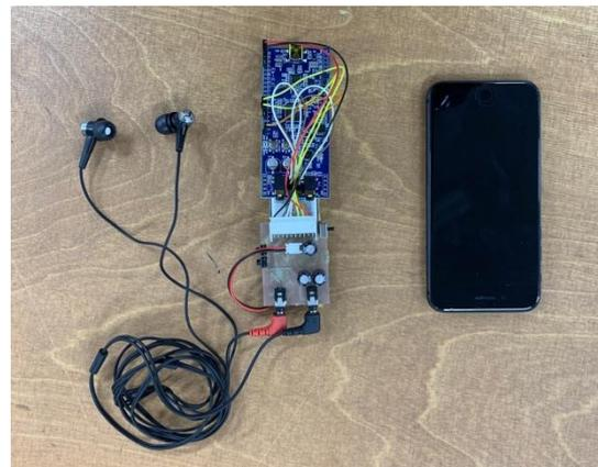
図12 左：DSP 基盤+アンプ+イヤホンマイク
